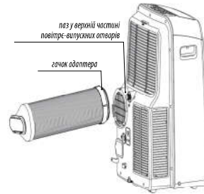
прикріплення повітропроводу до кондиціонера
