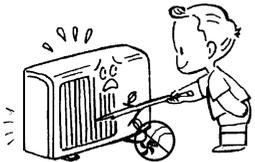
Не вставляйте посторонние предметы в воздуховыпускное отверстие комнатных и наружных блоков кондиционера. В них с большой скоростью работают вентиляторы, прикасаться к которым небезопасно.
