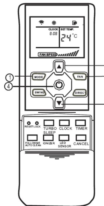
При установке кондиционера в режим FAN (ВЕНТИЛЯТОР), кондиционер начинает работать немедленно, раздувая воздух в качестве вентилятора. Для **Выключения** кондиционера нажмите кнопку ON/OFF.
