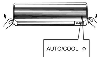
Поднимите переднюю панель, под которой расположены фильтры и кнопка запуска в тестовом режиме.
