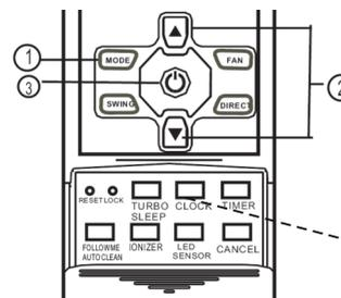
Перед началом работы кондиционера, установите часы на пульте, согласно инструкции, указанной в этом разделе. Часы на пульте будут показывать время независимо от того, работает кондиционер или нет.
