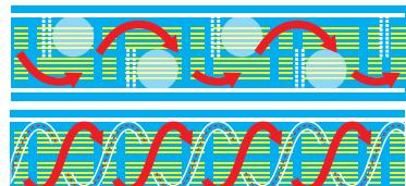
Организация вихревой геометрии протока воды (нижняя схема), исключает появление «мертвых зон» (полупрозрачные круги на верхней схеме, обозначающей поток в обычном кожухотрубном теплообменнике)
