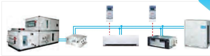
Подсоединительный комплект предназначен для подключения к системам MDV либо только к наружным блокам MDV приточных вентиляционных установок с фреоновыми испарителями. Могут использоваться вентиляционные установки любого поставщика. Комплекты поставляются 3-х типов: AHUKZ-01A – с возможной мощностью подключаемого испарителя от 9 до 20 кВт, и AHUKZ-02A – с мощностью от 20 до 28 кВт, AHUKZ-03A – с мощностью от 30 до 56 кВт.
