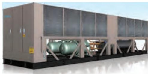
Винтовые чиллеры с воздушным охлаждением разработаны для обеспечения комфорного кондиционирования в помещениях большого объема либо для охлаждения больших объемов жидкости в промышленности. Midea производит 8 типоразмеров чиллеров в этой серии (от 375 до 1420 кВт). Агрегаты такого типа предназначены для монтажа на открытых площадках, и при этом осуществляют теплообмен с внешней средой с помощью встроенного воздушного конденсатора с W-образной конфигурацией.
