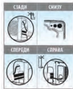
4 варианта подключения труб и проводки
