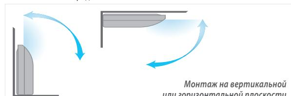
Монтаж на вертикальной или горизонтальной плоскости
