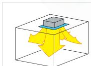
**За счет угловых вставок на панели достигается 360-градусный поток (4 дополнительных направления распределения воздушного потока)**
