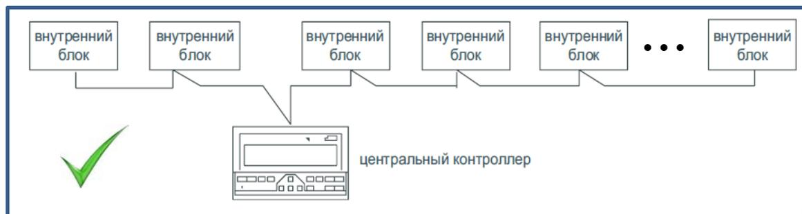
3. В системах V4+ series и выше, при наличии в системе одновременно ВБ с ручной и автоматической адресацией, ССМ30 **НЕЛЬЗЯ** подключать к наружному блоку, можно только по вариантам 1 или 2, приведенных выше.
