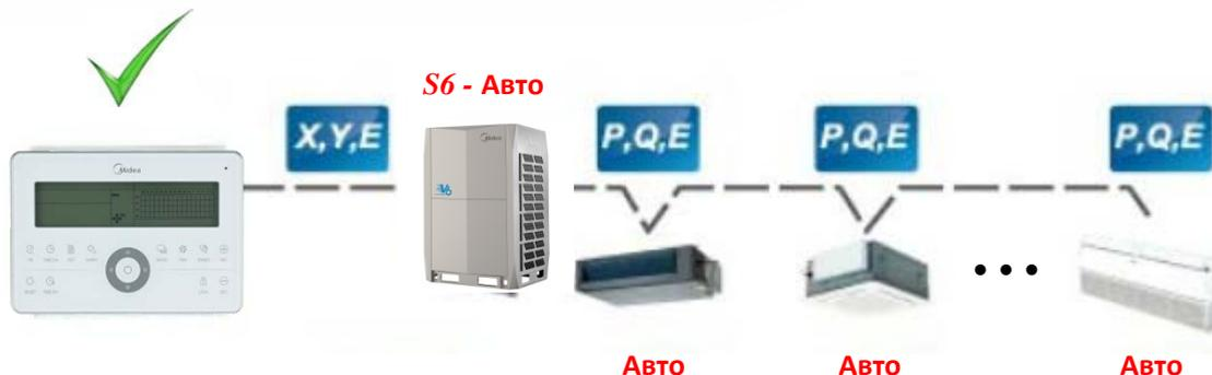
4. В системах V4+ series и выше со всеми ВБ имеющими автоматическую адресацию, ССМ30 можно подключить к наружному блоку (НБ), при этом переключатель S6 должен быть в режиме ручной адресации, а адреса ВБ введены вручную с ПДУ RM-05
